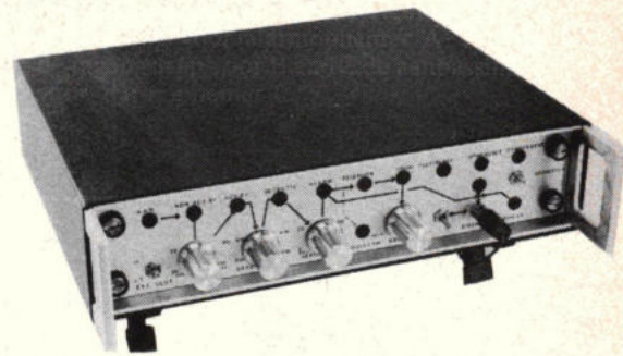
Afb. 1a. Een typisch voorbeeld van een centrale die is bedoeld voor slechts één (radar)bewegingsmelder. Het gaat hier om een demonstratie-unit, waarop alle functies zijn te bedienen en af te lezen.
